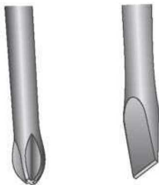
Рис. 1.9. Концы крестовой и плоской отверток
