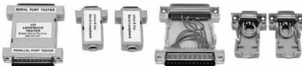
Рис. 1.18. Внешний вид и внутреннее устройство типичных тестовых разъемов
