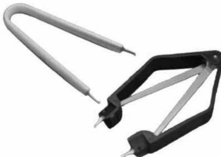
Рис. 1.17. Приспособления для извлечения микросхем из гнезд
